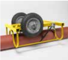
Fixer le tube au chariot retourné à l'aide d'une sangle à cliquet
