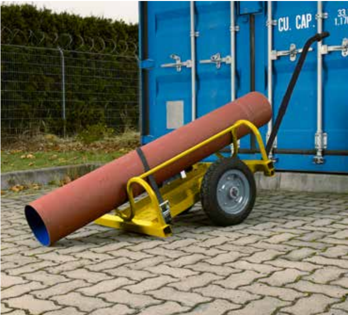
Fixer le tube au chariot retourné à l'aide d'une sangle à cliquet
