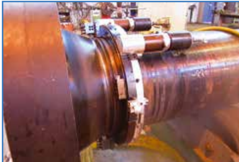
Deux moteurs pour une épaisseur de paroi extrême
