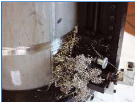
Enlèvement longitudinal du cordon de soudure
