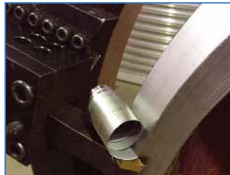
Extrême taux d'enlèvement du métal sur tubes P91
