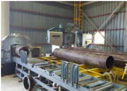
Línea de corte y biselado de tuberías
